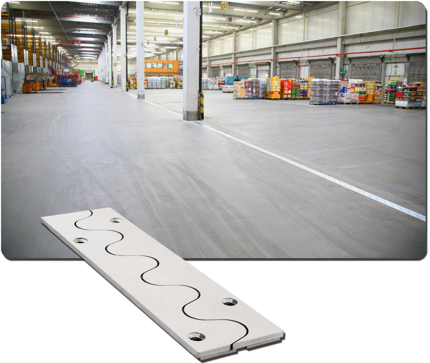
Schwerlastsanierungsprofil aus Stahl, Stahl verzinkt (vz) oder Edelstahl (VA) für den nachträglichen Einbau bei der Instandsetzung beschädigter, z.B. ausgebrochener Fugen im Rauminnen. Die Fugenausbildung als Sinuswelle garantiert durch ununterbrochenen Kontakt der Laufräder mit dem Schwerlastsanierungsprofil ("System Fugenlos") ein erschütterungsfreies Überfahren mit Flurförderfahrzeugen unabhängig von Größe und Härte der Bereifung.
